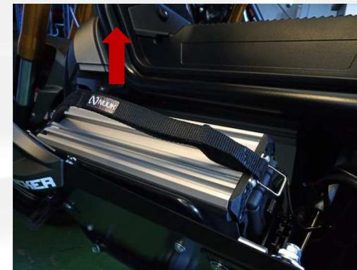
Para instalar las baterías de nuevo, siga la secuencia anterior a la inversa: introduzca la batería en la jaula, coloque las anillas de los extremos de la cinta en los ganchos de la jaula y fíjelo apretando el velcro de la cinta, conecte el conector siempre con la moto apagada, empuje la puerta hacia adentro para colocarla en posición y fíjela girando las cerraduras para que la cara interior de las mismas apunte al centro de la motocicleta. Por último, bloquee las cerraduras con la llave.
