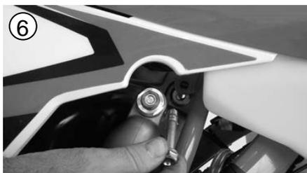
8. Extraiga el tornillo de sujeción superior del amortiguador al chasis (6).
