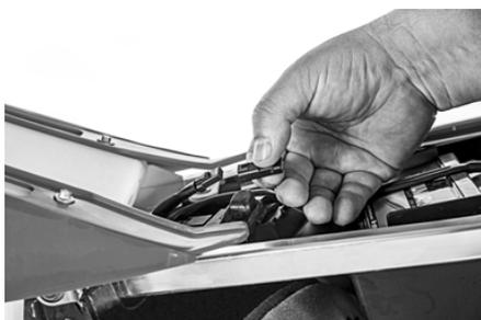
Para conectar el scan-tool Creader VI+ (o similar) se debe sacar la protección al conector.
