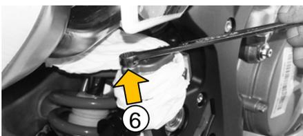
5. Afloje los tornillos (6) y saque la tapa del depósito de líquido de frenos.
