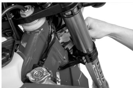
Su RIEJU dispone de un antirrobo por bloqueo de dirección. Se encuentra en el lado derecho de la brida inferior de la horquilla. Para bloquear la dirección:
