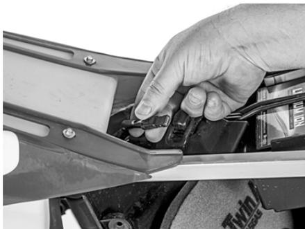
Se puede conectar con el sistema OBD utilizando una máquina de diagnóstico compatible con el protocolo ISO 15765-4 CAN. Para conectar la toma de 4 vías de la instalación de la moto con la máquina de diagnóstico (Conector JAE de 18 pin) se necesita el cable interface que se puede adquirir a través del departamento de recambios RIEJU, con la referencia EM10225TT-CLR-1
