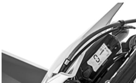
El sistema OBD (On Board Diagnostic) Incorpora una luz testigo MIL para indicar algún malfuncionamiento. Al arrancar la moto se enciende la luz MIL (Malfunction Indicator Light) que está integrada en el display.
